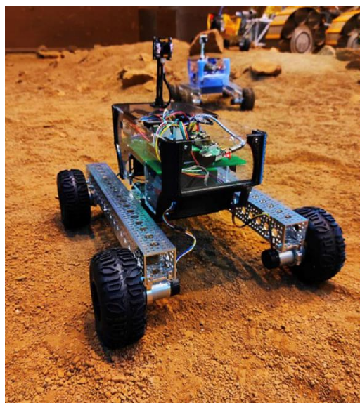
La versione 4 ruote motrici del robot MARRtino 4W nell'arena di gara (ROCC di Altec)
